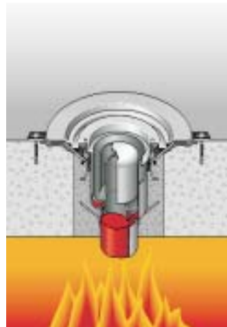
Bild 10: Die brandschutztechnische Funktion.
