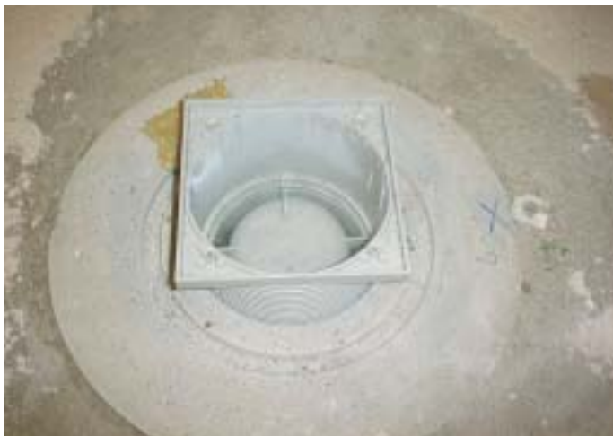
Bild 11: Bodenablauf nach 120 Minuten Brandprüfung mit bis zu 1000°C im Brandraum. Die Wasservorlage ist noch erkennbar.
