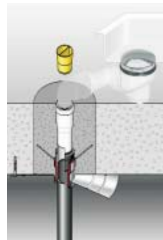
Bild 12: Viega adventix Duschablauf R 120 mit allgemeiner bauaufsichtlicher Zulassung Z-19.17-1430.
